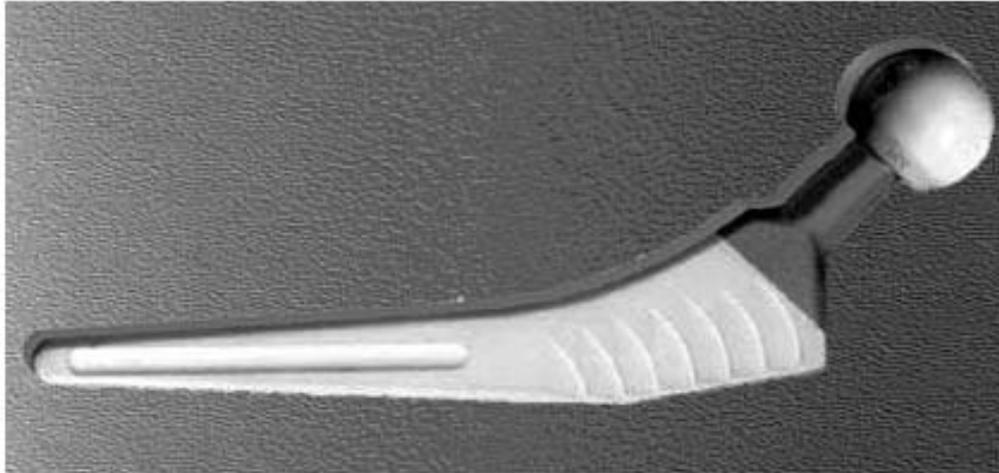
**Figura 1.** Prótesis de cadera hecha a base de titanio con el vástago femoral cubierto de hidroxiapatita para mejorar su fijación al hueso vivo.
