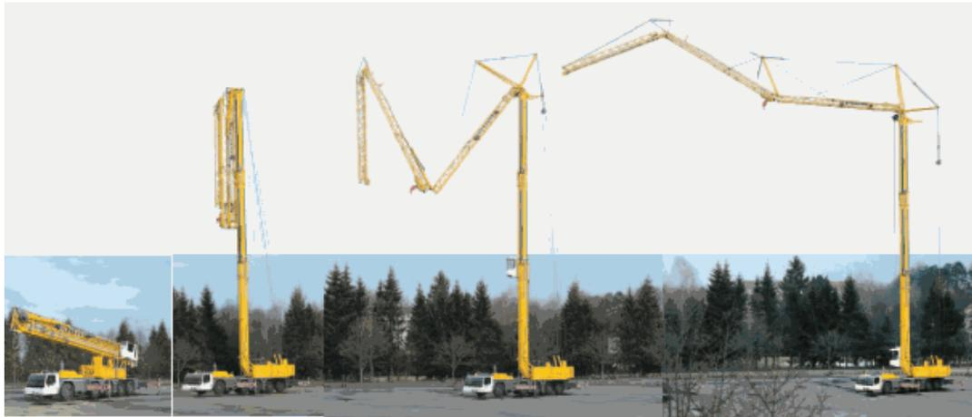
3. Grúa torre autodesplegable monobloc: Grúa torre autodesplegable cuya torre está constituida por un solo bloque y que no requiere elementos estructurales adicionales para su instalación, que puede ir provista de ruedas para facilitar su desplazamiento.
