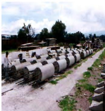
A las columnas oblongas se le puede colocar accesorio para conexión tipo ménsula y barbas recibidoras de muros de cortante, pero no se hace ya que el costo de fabricación se elevaría drásticamente, así que cuando se diseña un edificio con este tipo de columnas se debe hacer lo mas uniformemente posible para que no tenga detalles de construcción complejos de conexiones.
