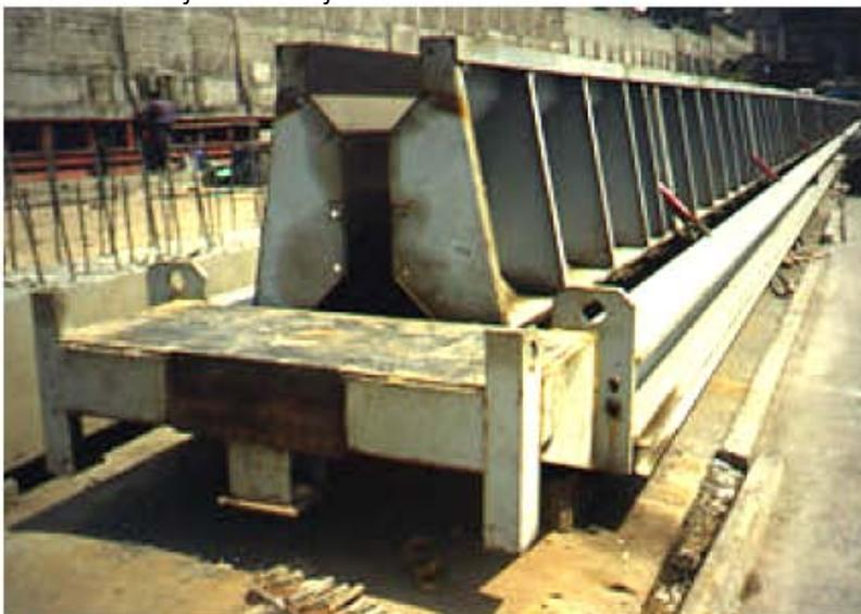
Molde metálico autotensable de sección "I"
