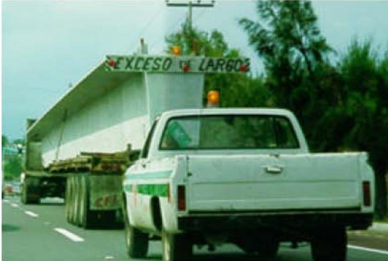
Módulo (M): Plataformas acoplables longitudinal y lateralmente, con ejes direccionales y suspensión hidráulica o neumática.
