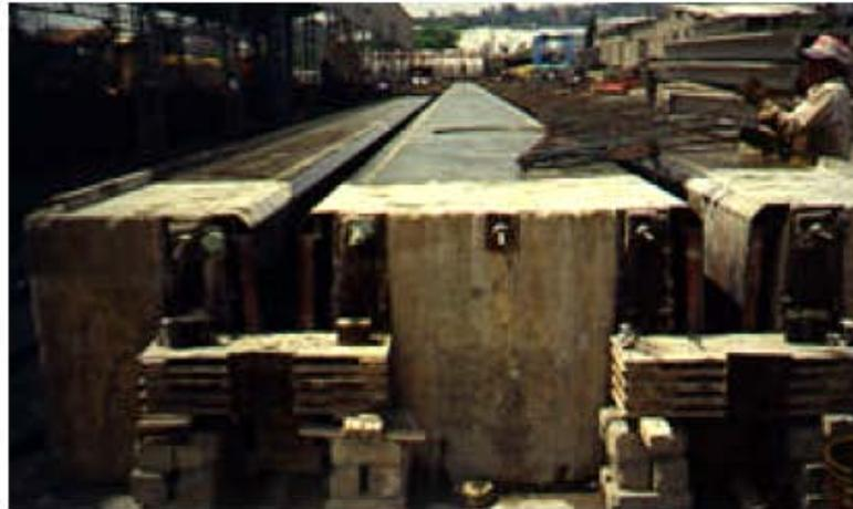
Molde y mesa de colado de concreto presforzado para traveses doble T
