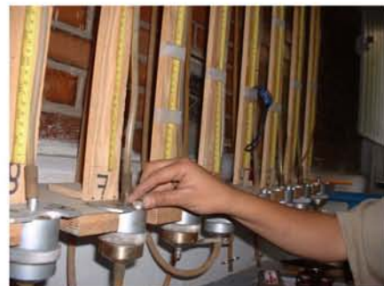
Figura 4.29 Colocación de permeámetros
