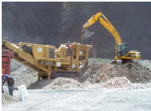
Figura 2.10 Alimentación del proceso por medios mecánicos.
