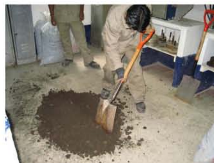
Figura 4.40 Cuarteo de material y fabricación de mezclas
