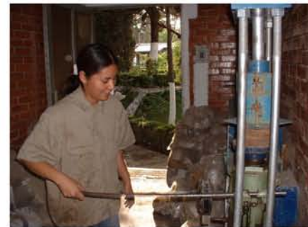
Figura 4.34 Aplicación de carga en el espécimen
