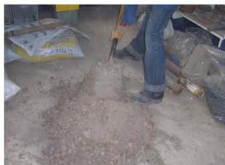
Figura 4.13 Cuarteo de muestras representativas
