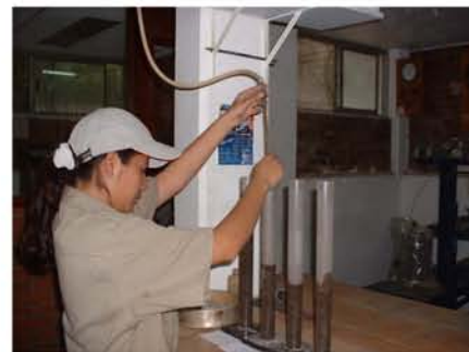
Figura 4.26 Vertido de solución en probetas con material
