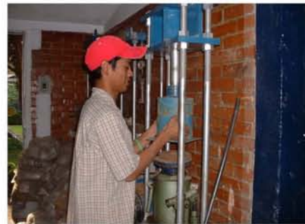
Figura 4.33 Colocación del molde en la prensa
