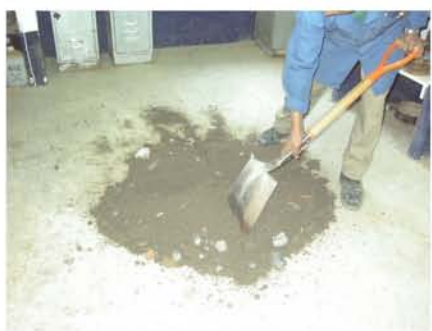
Figura 4.8 Cuarteo de material en laboratorio
