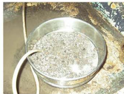
Figura 4.17 Lavado de material que pasa la malla 4
