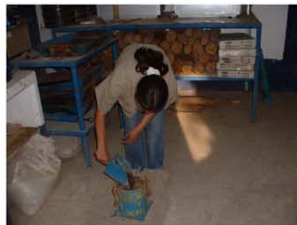
Figura 4.23 Llenado del molde de volumen conocido
