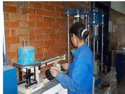
Figura 4.22 Determinación del peso seco suelo
