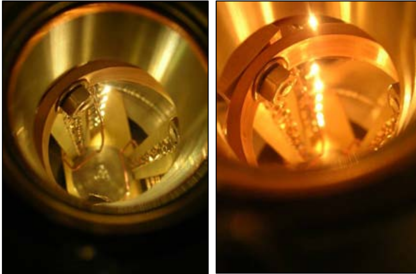
Figura 23. Proceso de degasificación de una torre de 24 filamentos, que se realiza aplicando una corriente eléctrica a través de ellos.
