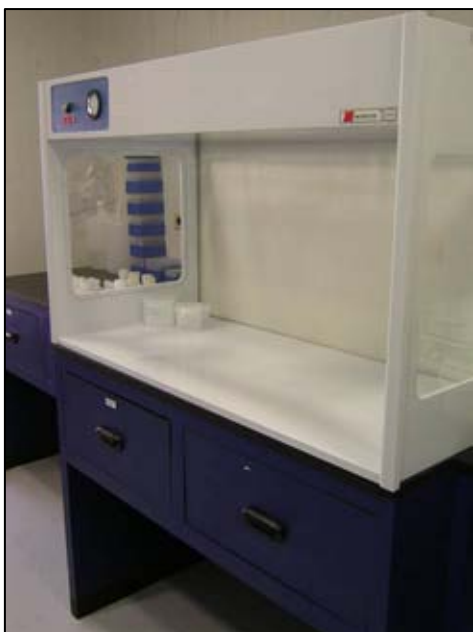
Figura 18. Campana de flujo laminar de calidad de aire 10 dentro de la cual se prepara la ISS, y se realiza el procedimiento de separación de los elementos para el análisis isotópico.
