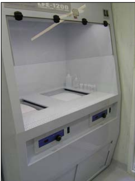
Figura 17. El proceso de digestión con ácidos se realiza dentro de una campana de extracción y flujo laminar, con filtración de aire adicional, dentro de la cual se obtiene una calidad de aire \leq 100 .
