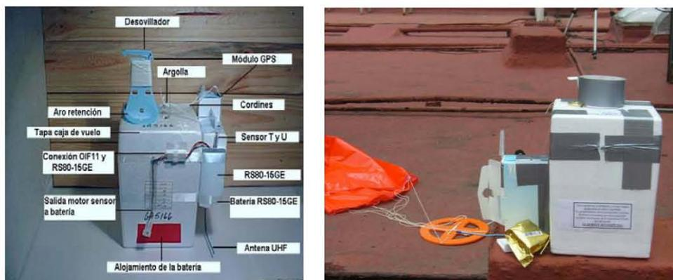
**Figura 2.2. Ozono sonda lista para ser lanzada (Sancho, et al. 2001)**
