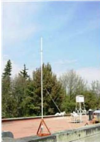
*Figura 2.8 Antena de detección de relámpagos del CCA*
