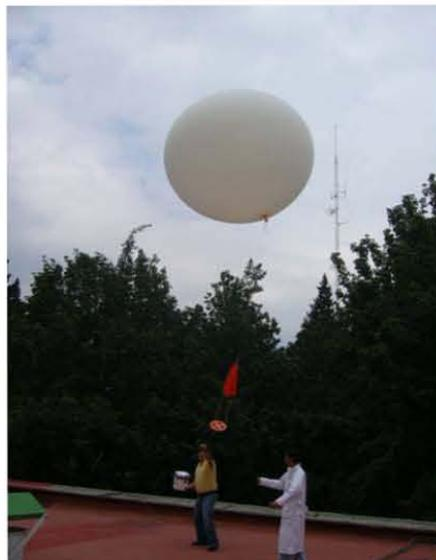
**Figura 2.6 Lanzamiento del globo con la ozono sonda.**
