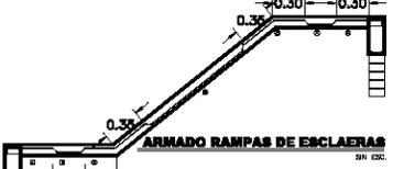
ARMAR LA RAMPA CON VARELLAS 1.-POR EL LECHO BAJO A CADA 24 ALTERNADO CON 2.- DOBLADAS AC 24 DE MODO QUE EN A (EMPOTRES TENDREMOS ARMADO EN LOS DOS LECHOS EN B POR EL LECHO BAJO AC 12 EN C (DOBLARSE ) POR LOS LECHOS ALTOS AC 24 Y COMPLETAR EL ARMADO CON BASTONES TRANSVERSALES A C 20
