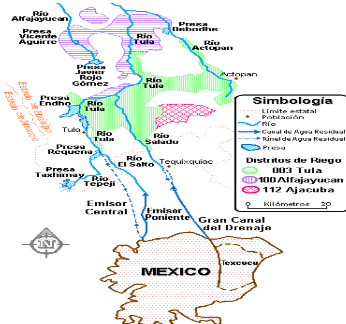
Figura 1.1. SISTEMA DE DRENAJE DEL VALLE DE MÉXICO
