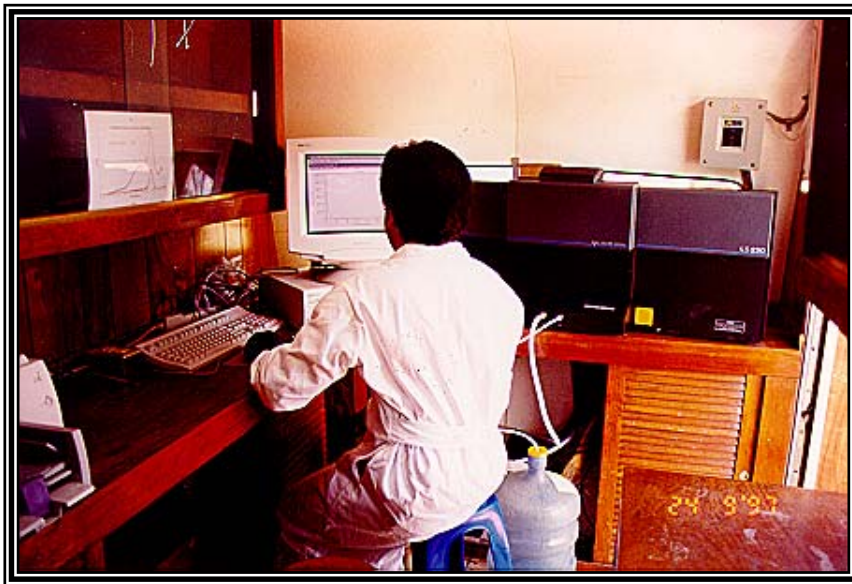
Figura 3.10. Contador de partículas, COULTER® LS 230
