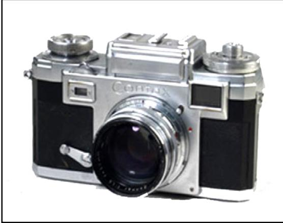
el telémetro del visor, de forma que si se ve una imagen doble o rota en éste hay que girar el mando de enfoque hasta que ambas imágenes coincidan en una sola.
