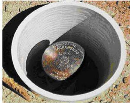
Figura 2.15 Testigo tipo usado en trabajos de monitoreo de hundimientos superficiales por el USGS.
