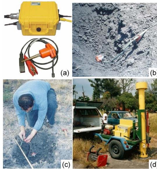
Figura 4.4 Algunos aspectos del levantamiento de datos sísmicos. (a) Equipo de exploración sísmica usado en la determinación de las constantes elásticas. Sismómetro Geode ES-3000 marca Geometrics. (b) y (c) Colocación de geófonos. (d) Fuente de onda elástica. Martillo neumático de 50 lb.
