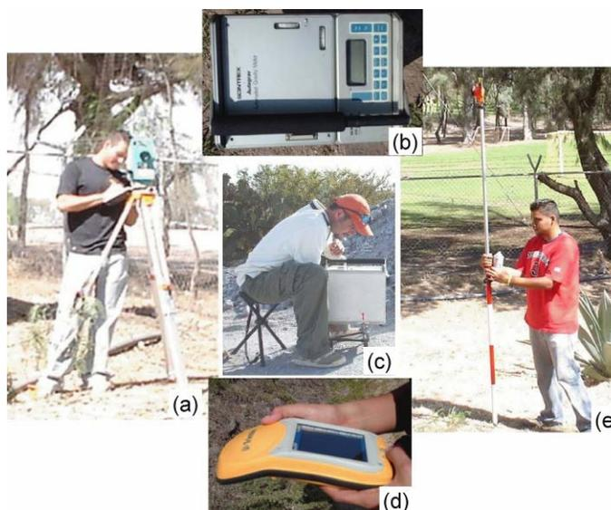
Figura 4.1 Algunos aspectos del levantamiento de datos gravimétricos. (a) y (e) Trabajos de nivelación con estación total sobre los puntos de medición gravimétrica. (b) Gravímetro Scintrex CG-3 empleado para las mediciones de gravimetría. (c) Mediciones de gravimetría. (e) GPS usado para el geoposicionamiento de los puntos de medición gravimétrica
