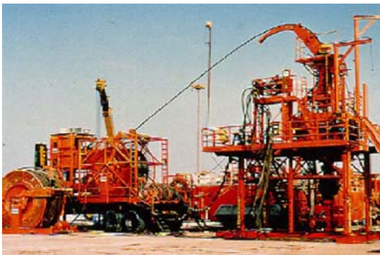
Figura IV.13. Unidad Híbrida para Perforar con T.F. en Oman (Dowell). 2
