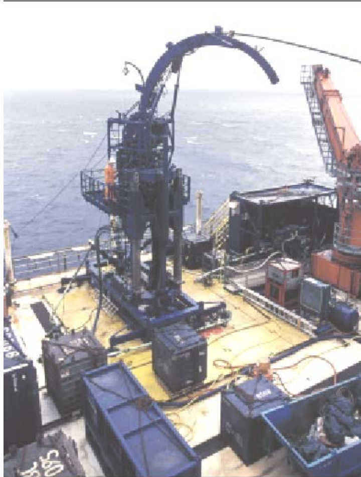
Figura VI.2 Una Plataforma del Campo Valhall en el Sector Noruego del Mar del Norte. La nueva unidad CT SEAS ejecuta operaciones de disparos y limpiezas de pozos antes y después de los tratamientos de fracturamiento hidráulico con apuntalante en el campo Valhall de BP. 17
