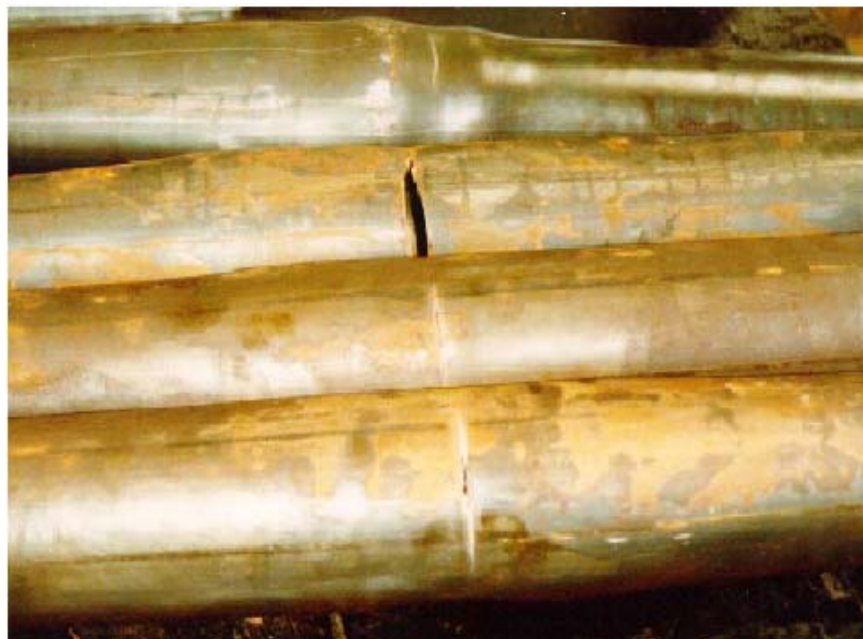
Figura II.22. Fallas por Fatiga en la Tubería Flexible. 2
