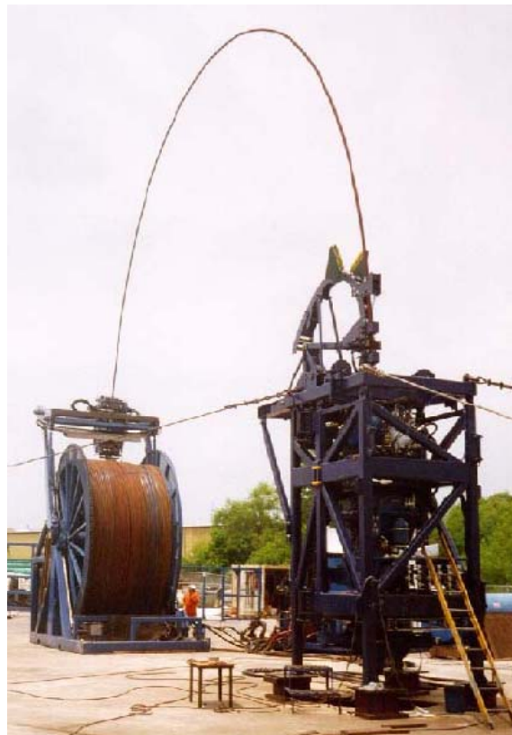
Figura II.26. Un Arco Parabólico en la T.F. Minimiza el Daño por Fatiga. 2
