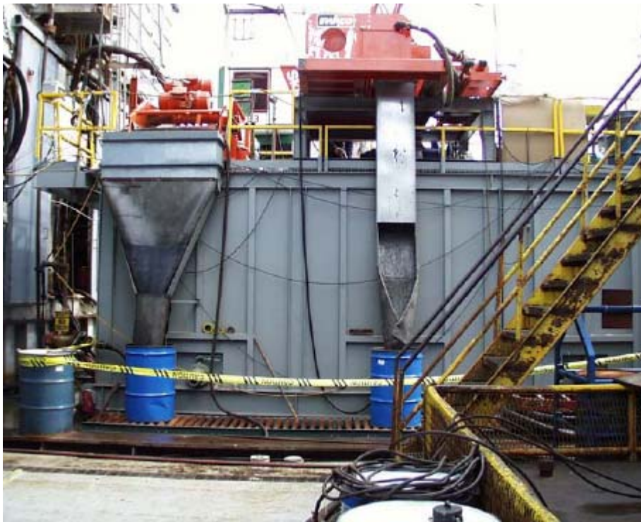
Figura IV.44. Sistema de Eliminación de Sólidos para un Pozo Perforado con Tubería Flexible (Unocal, Alaska). 2
