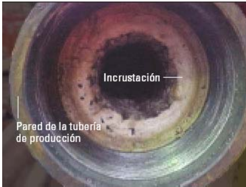
Figura VI.11. Acumulación de Incrustaciones en los Tubulares del Pozo. 17
