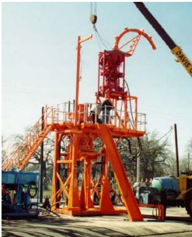
Figura IV.61. Subestructura con sistema de levantamiento. 2
