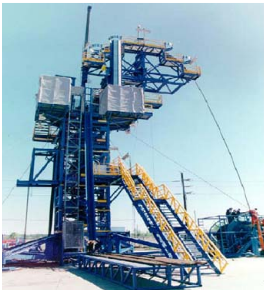
Figura II.24. Radio de Arco Guía Extremo para Reducir el Daño por Fatiga en la T.F. 2
