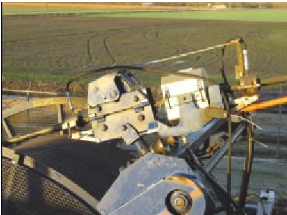
Figura VI.8 b. Dispositivo para medir el Espesor de la Pared de la Tubería Flexible a medida que sale del Carrete. 17
