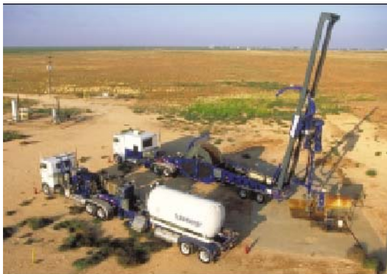
Figura VI.5. Unidad de TF Terrestre, diseñada a la Medida de las Necesidades. 17
