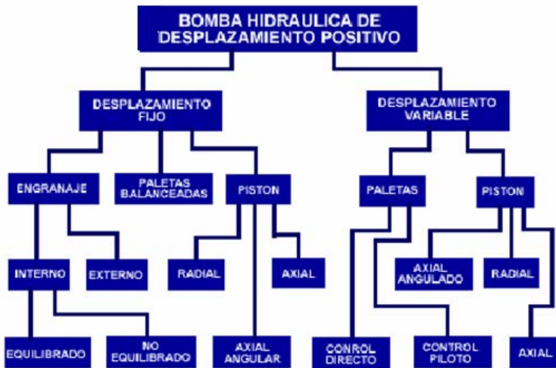
Figura II.43. Tipos de Bombas Hidráulicas.
