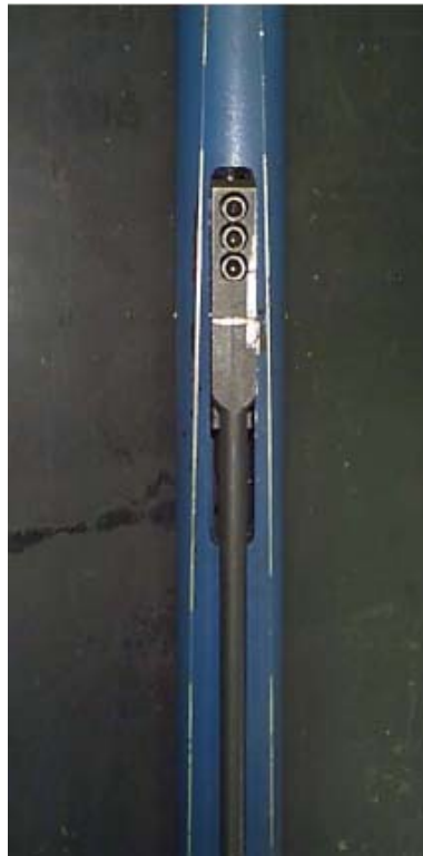
Figura IV.59. Cima de un Desviador a través de la Tubería de Producción mostrando el Bloque de Cizalla (bot). 2
