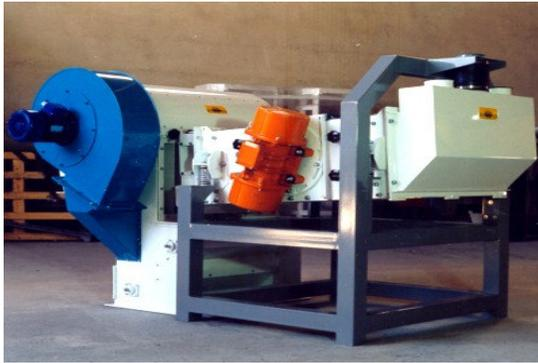
Por medio de un separador vibratorio se puede realizar la separación de la materia prima de materiales indeseables como: grumos de tierra, pedazos de madera, piedras y restos de pulpa entre otros.
