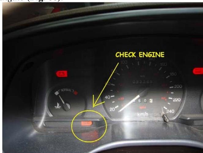
Fig. 66 Tablero de instrumentos del vehículo donde se puede apreciar que la luz testigo se encuentra encendida.
