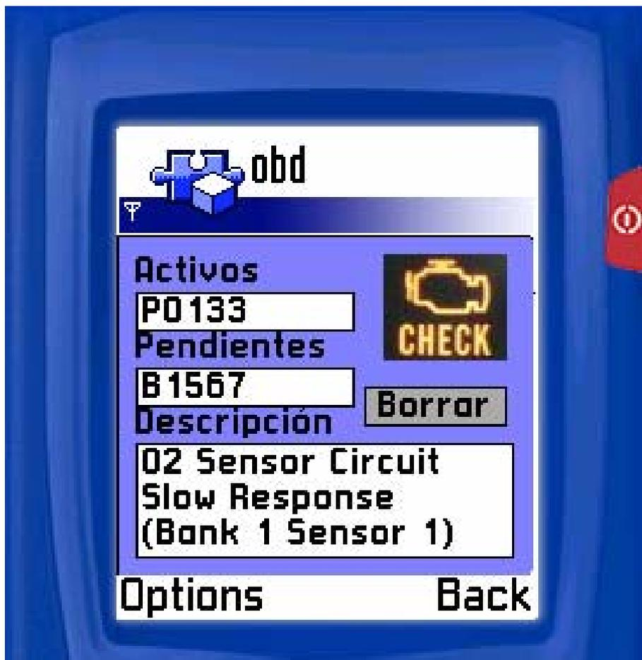
**Fig.63** Despliegue del programa para interpretar **DTCs** en el emulador **S60** de Nokia.
