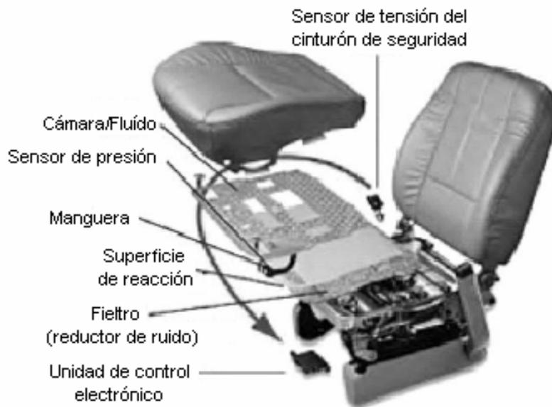
**Fig.3** Sistema de Detección de Ocupante Pasivo.
