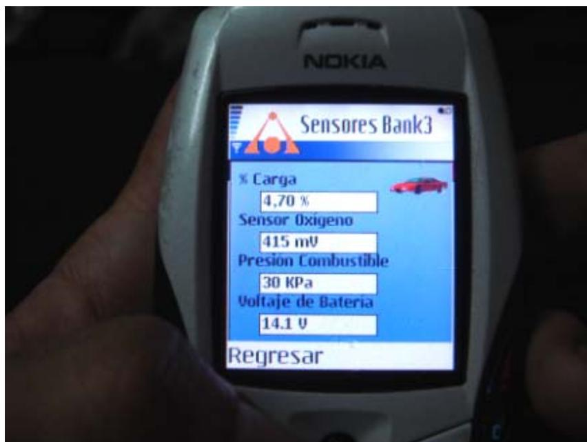
**Fig. 76** Escaneo de los sensores vía teléfono celular, aquí se pueden apreciar los valores de la carga del motor, el voltaje del sensor de oxígeno, la presión del combustible y el voltaje de la batería.
