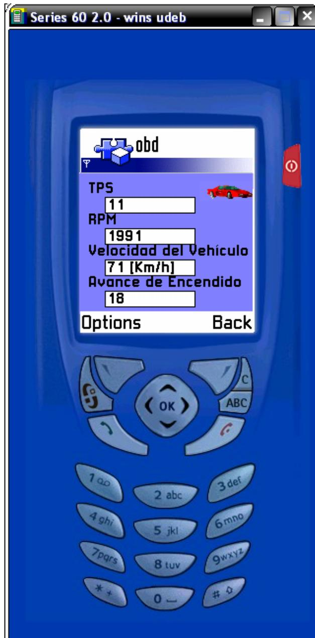
**Fig.60** Despliegue del programa para escanear sensores en el emulador S60 de Nokia.
