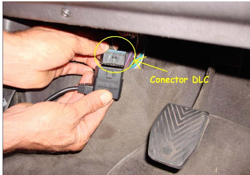
**Fig. 73** Ubicación del conector de enlace de diagnóstico DLC en el Neon 96.
