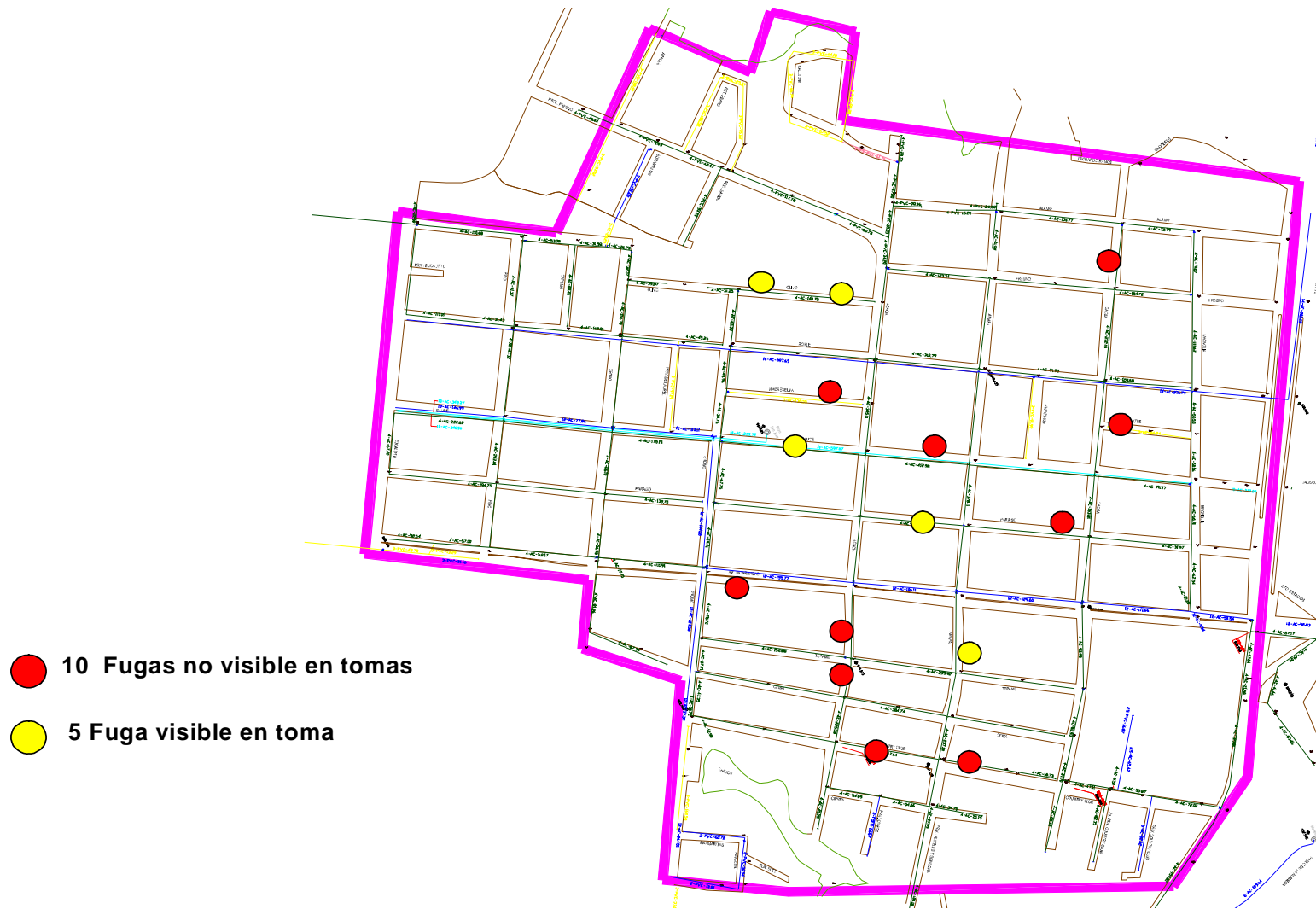
Figura 3.20. Sitios de fugas en tomas domiciliarias en el DH San Juan
