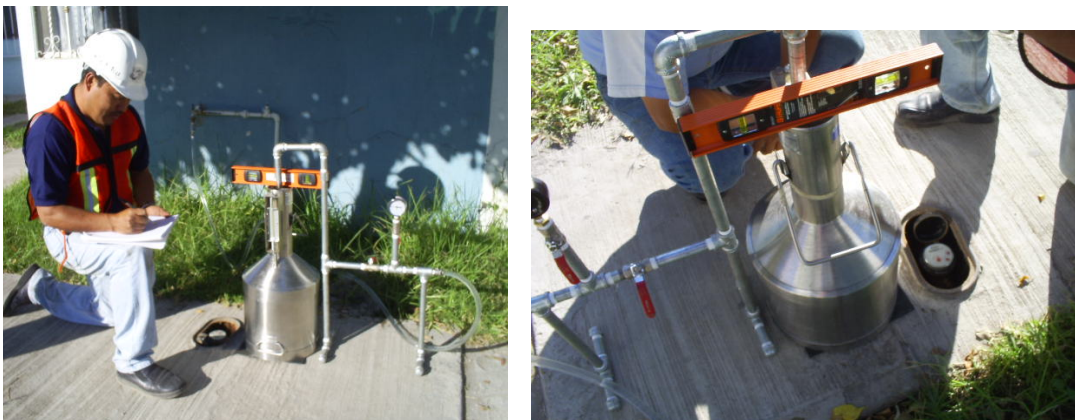
Figura 3.12. Evaluación de Micromedidores en campo
