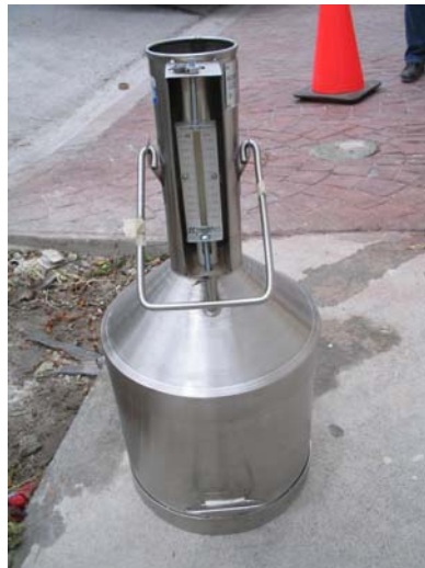
Figura 3.11. Jarra patrón de 20 l, de la marca Braunker, calibrada en laboratorio acreditado conforme a las normas vigentes NOM-041- SCFI-1997, NOM-042-SCFI-1997 Y LA NMX-CH-049-1996-IMNC.
