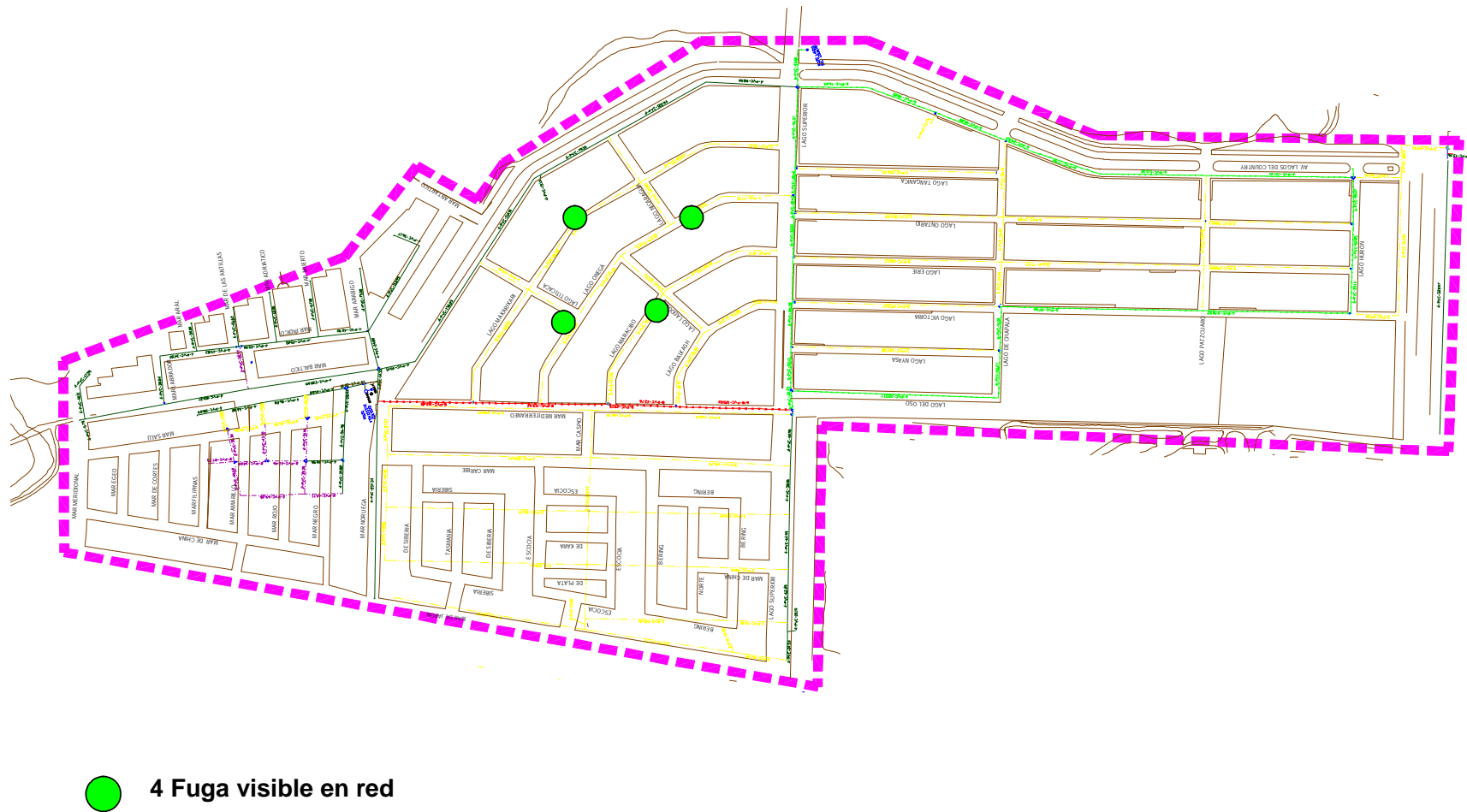
Figura 3.24. Sitios de fugas en red del DH Lagos del Country
