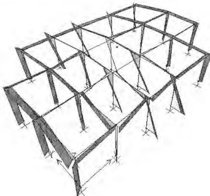
Figura 8 Diagrama de momentos eje 2-2
