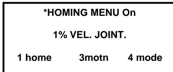
6. Presionar la tecla SPEED UP 2 veces hasta llegar a 10% de velocidad y poder mover el robot a velocidad lenta
