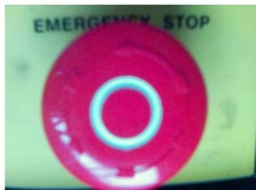
Fig. 6.7 Botón de paro de emergencia del controlador C500C CRS
