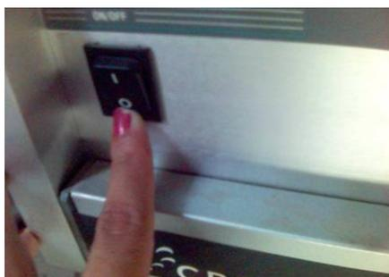
Fig. 6.18 Apagar el interruptor ON/OFF del controlador
