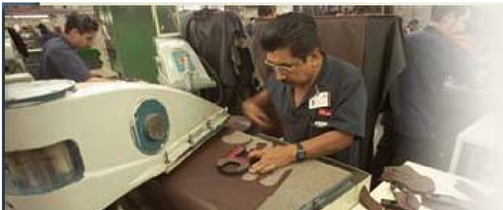
Fig. 1-7 Proceso de suajado elaborado en grupo Flexi.
