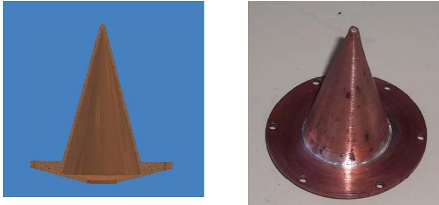
Figura 4.3. Corte trasversal y fotografía del cono receptor.
