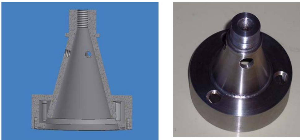
*Figura 4.2. Corte transversal y fotografía del cuerpo principal del calorímetro.*
