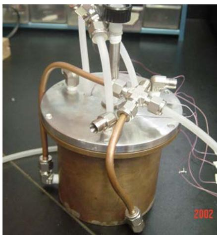
*Figura 5.4. CAVIRAD armado e instrumentado listo para hacer experimentación.*
