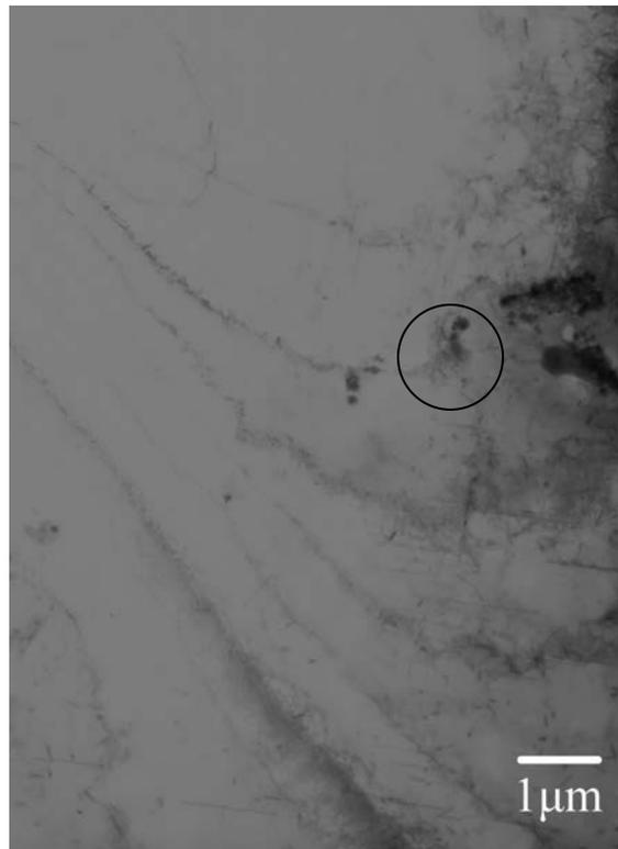
Figura 4.9 Imagen de microscopía electrónica de transmisión para la aleación Al-2.27%Zn-0.98%Mg (% en peso),  $t=47h$  6000X con área selecta para difracción
