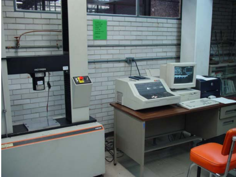
Fig. 1.2 Ensayo de compresión en máquina Instron modelo 4206, FI UNAM
