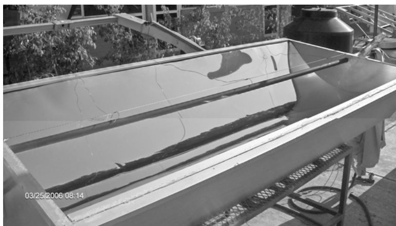
Figura 2.2. El colector concentrador de canal parabólico.
