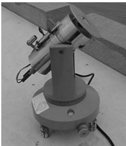
Figura 4.2. Pirheliómetro para medir radiación directa
