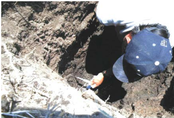
Observamos a personal de campo realizar en el PCA-A, una toma de muestra con penetrómetro 3 de material que se analizará posteriormente en laboratorio, para calcular su resistencia.
