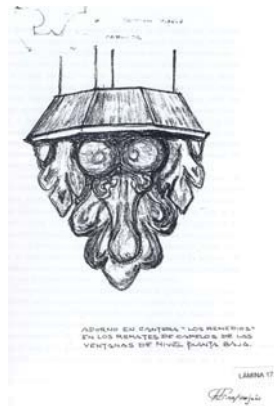
Lam. 17. Detalle de adornos de los capelos de ventanas del Edificio de la VI Inspección.
