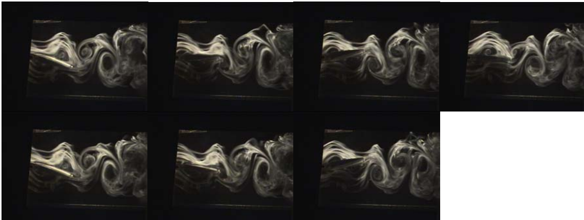
Figura 3.9 Interacción constructiva donde el vórtice generado en el borde de entrada se desplaza a lo largo de la superficie del perfil y luego se fusiona con el vórtice generado por el movimiento del borde de salida.
