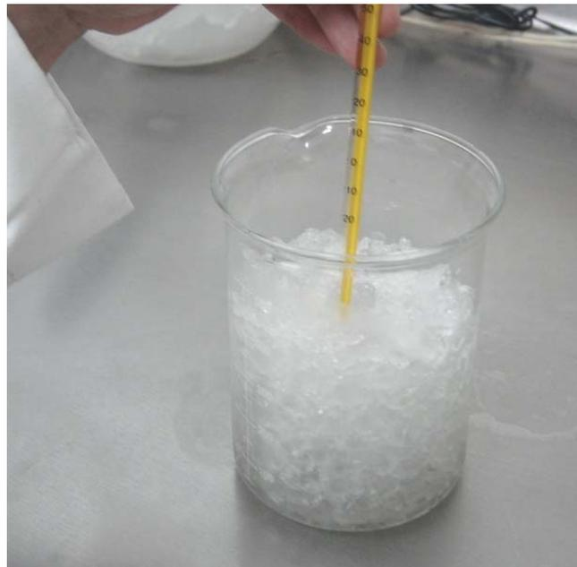
Colocar el vaso con el hielo en la parrilla previamente calentada. Comenzar a medir la temperatura minuto a minuto y a registrar los cambios observados en la muestra.
