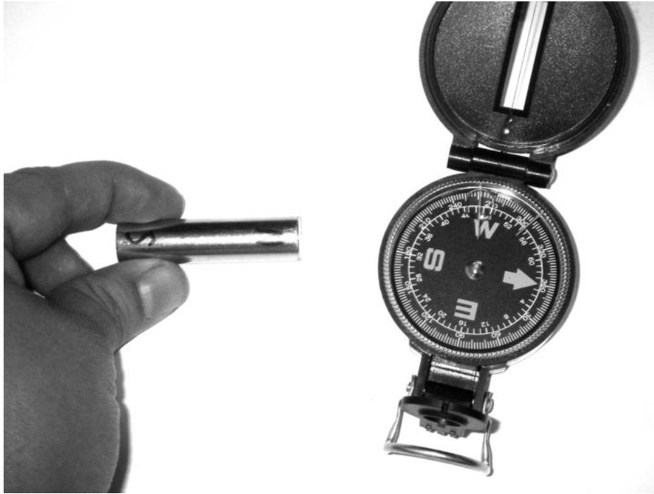
Figura 8.4.3 Determinación de la polaridad del imán con una brújula
