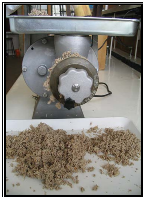
Figura 3. Molino de nixtamal y de granos uso doméstico NIXTAMATIC
