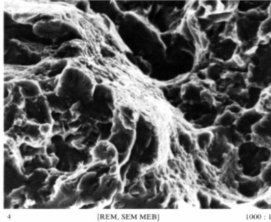
Figura 2.8. Muestra de un acero 1045 templado y revenido.<sup>III</sup> La microfotografía electrónica muestra la zona híbrida típica de una fractura semifrágil.
