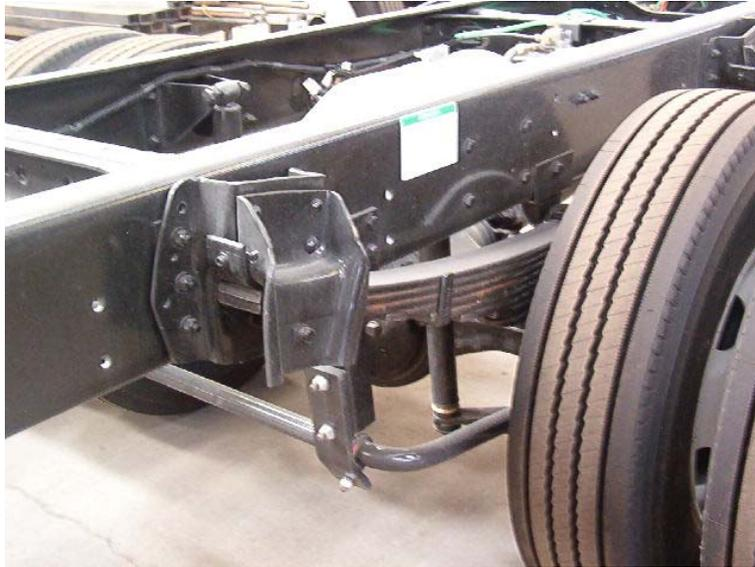
Figura 3.7. Disposición típica de una barra estabilizadora en un eje trasero
