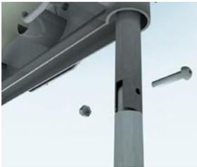
Esta pieza se une a un tubular de la estructura de la cubierta que paso por fresado para lograr la ranura central y un barreno. Ambas piezas se unen por medio de un tornillo con tuerca de seguridad que funcionan como punto de giro.
