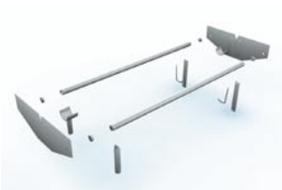
La estructura de la cubierta, conformada por 2 placas lateras que se cortan por chorro de agua y tubulares cortados con sierra, se une por medio de soldadura TIG, ya que es una pieza fija, que servirá como soporte al resto de la cubierta.
