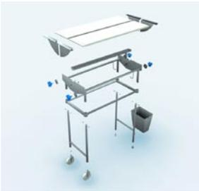
La mesa diseñada está pensada para fabricarse a través de procesos sencillos, contando con distintas uniones y tipos de ensamble dependiendo de la función que cumple cada una de las piezas. Se utilizan tres tipos de ensambles en las distintas partes que conforman la mesa, estas son: adhesivos, tornillería y soldadura.
