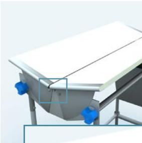
Las placas laterales de la estructura superior permiten que las cubiertas de Nylamid se recarguen sobre estas. La sujeción de estas piezas es a través de tornillos y tuercas de seguridad, que sirven como punto de giro para permitir movimiento a la cubierta en "V".
