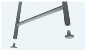
Los tubulares se cortan con sierra y posteriormente son soldados. En el caso del tubular horizontal, requiere de un fresado para embonar completamente con la curva del tubular vertical.
