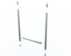
La estructura de las patas consta de dos piezas formadas por tres tubulares cada una, dos verticales y uno horizontal. Teniendo como resultado dos estructuras, una larga y una corta.
