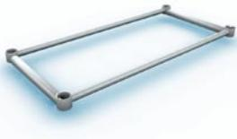
El seguro de las patas esta formado por una estructura que consta de dos tubulares y dos medias cañas, logradas a través de un rolado de lámina y cizallado. Los tubulares y las medias cañas se sueldan a 4 pequeños tubulares de mayor diámetro. Estos permiten que el seguro suba para cerrar la mesa o baje para fijar las patas y evitar que estas se cierren o abran mientras esta en uso.
