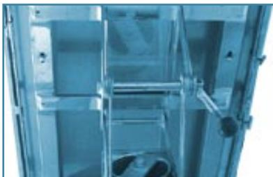
Funciona por medio de una leva y se asegura con un palanca cuando alcanza la inclinación deseada.
