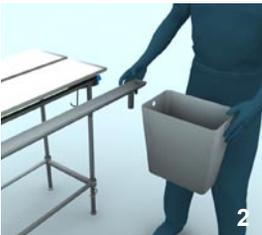
2. Quitar el bote de basura y el canal de desagüe para poder limpiarlos y llevarlos aparte. El canal puede llevarse por separado o volverse a colocar.
