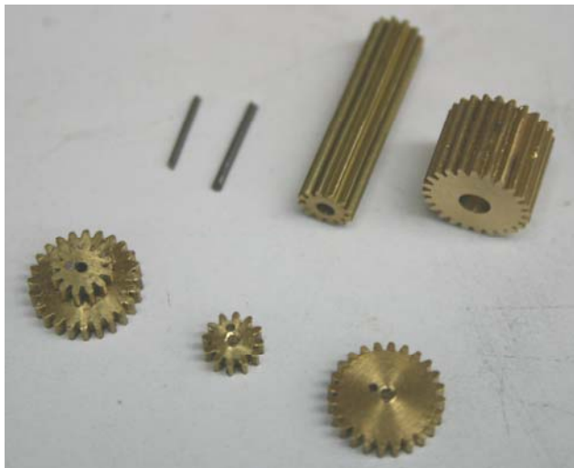
Figura 3.16 Manufactura y ensamble de los engranes
