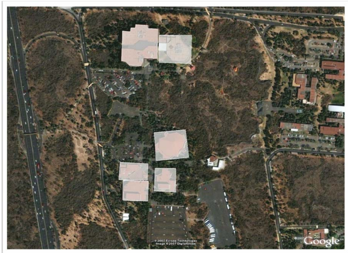
Figura 3.13 Edificios de la zona de estudio los recuadros en blanco representa como fueron representados los edificios en ancho y largo en la generación de los archivos de entrada para uMM5.
