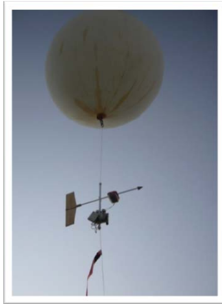
Figura 3.10 Sonda cautiva empleada en ambas zonas, apréciase la instrumentación que cuenta con una veleta, sensores de temperatura, humedad y anemómetro.
