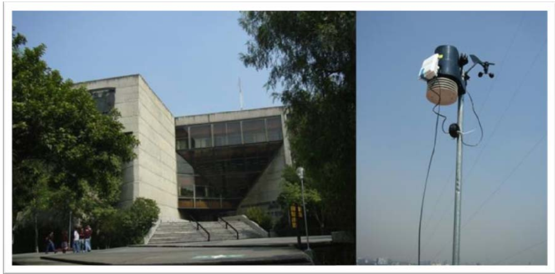
Figura 3.8 Estación meteorológica DAVIS ubicada en la zona urbanizada. La foto de la izquierda corresponde al edificio que en su parte superior se instaló la estación Davis que como se observa en la foto de la derecha cuenta con una veleta, anemómetro, sensor de humedad y pluviómetro.
