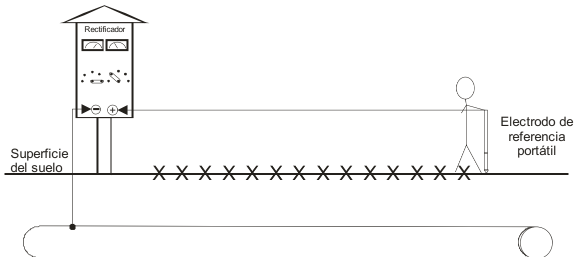
Figura 5. Técnica de mapeo a intervalo cerrado, CIS, por sus siglas en inglés
