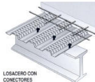
Figura 2.8. Esquema ilustrativo del Sistema de Piso con elemento estructural.
