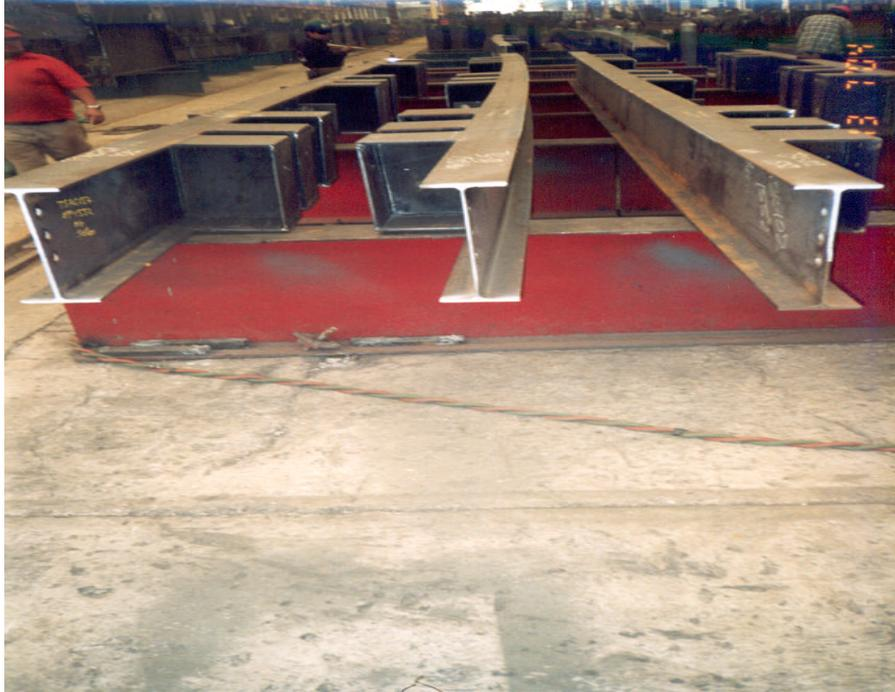
Elemento Estructural Deformado por el Proceso de Habilitado.
