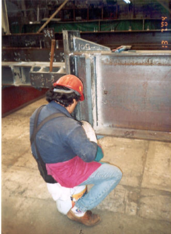
Procedimiento de Limpieza Manual a Elemento Estructural.
