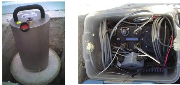
*Figura 4.5 Sismómetro Guralp CMG-3T (izquierda) y registrador Reftek (derecha) de tercera generación de registradores sísmicos, modelo REF TEK 130- 01.*
