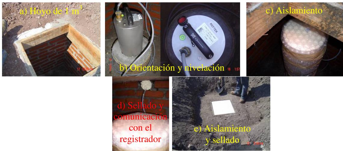
Figura 4.2 Instalación del sensor. a) Hoyo de sensor aproximadamente de 1 m de profundidad. b) Orientación y nivelación del sensor dentro del hoyo. c) Sensor ya instalado, cubierto por un tubo de PVC. d) Poliburbuja alrededor del tubo para protegerlo del agua y cable que se conecta al registrador. e) Aislamiento térmico del sismómetro con bloque de polietileno.
