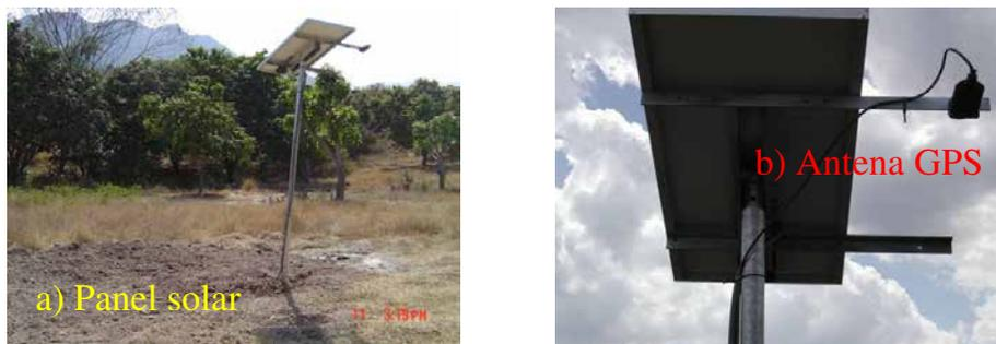
*Figura 4.4 a) Panel solar que brinda energía al equipo. b) Antena de GPS*
