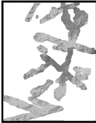
**Figura 2.2** Cristales intermetálicos sin modificación en una aleación aluminio-silicio. [18]
