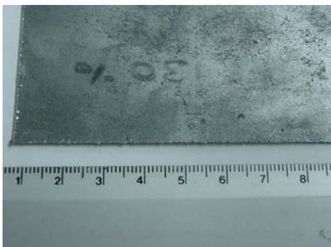
**Figura 4.9** P1 TT con deformación del 130%
