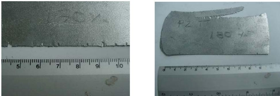
**Figura 2.12** Ejemplos de defectos resultantes por ensanchamiento lateral. Imagen de un lingote de aleación SAE 788 después de una deformación de 180% y otro con el 170%
