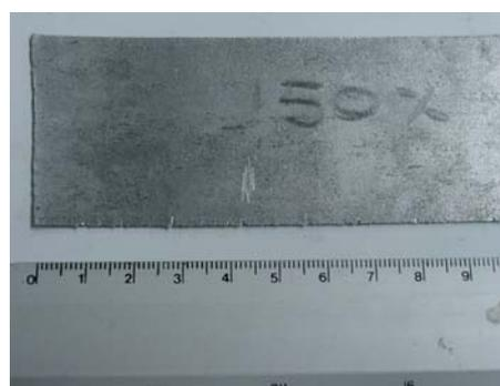
**Figura 4.10** P1 TT con deformación del 150%
