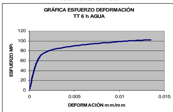
**Gráfica 3.25** Resultados de los extensómetros de las probetas sin tratamiento térmico para la probeta con tratamiento térmico de 6 horas con enfriamiento en agua.
