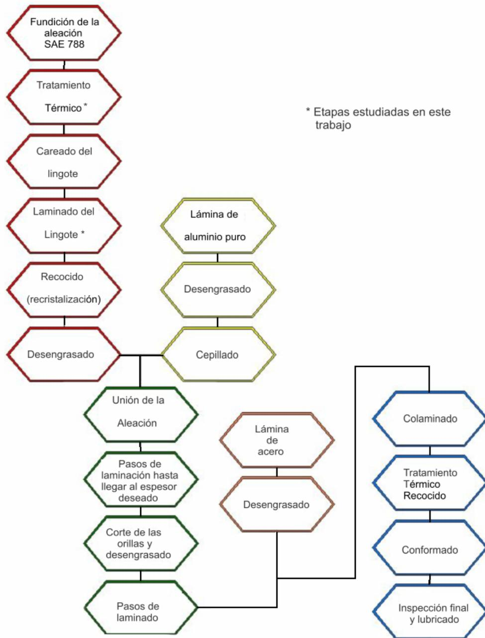
Figura 3.1 Proceso de conformado de cojinetes.
