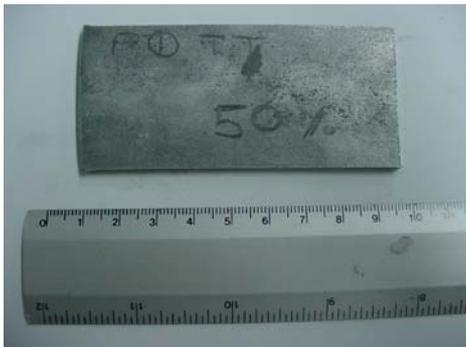
**Figura 4.7** P1 TT con deformación del 50%
