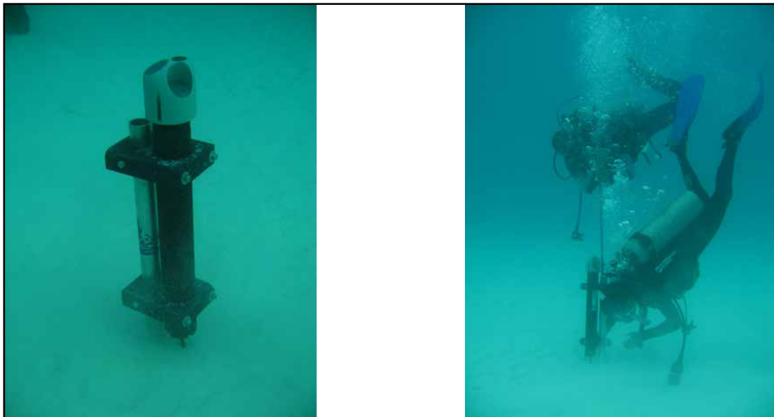
Figura 4.- Izq. Perfilador Acústico Nortek de 0.6 Mhz. Der. Instalación del ADCP por medio de la técnica de fluidización de arena. Ambas fotografías son del instrumento localizado en Playa del Carmen.
