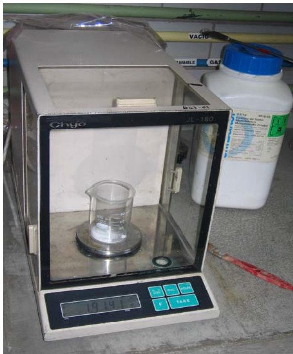
Fotografía 6. Balanza Chyo, triple viga con pesas, modelo JL-180. Utilizada para la determinación de SST y SSV y para pesar reactivos para soluciones.
