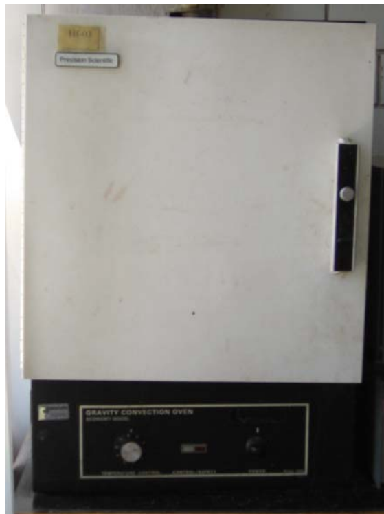
Fotografía 4. Horno Gravity Convection Oven para determinación de SST, SSV y DQO.
