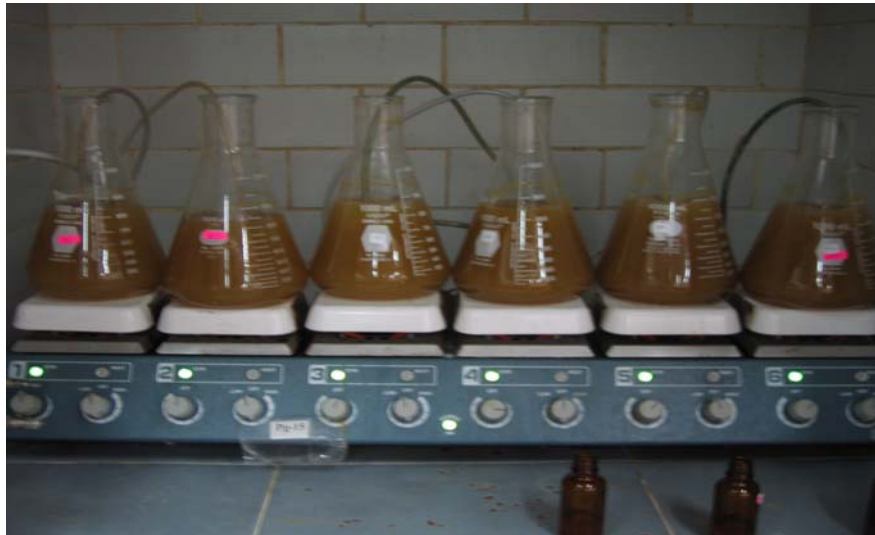
Fotografía 10. Sistema de reactores por lotes aerados con agitación para las cinéticas 2 y 3.
