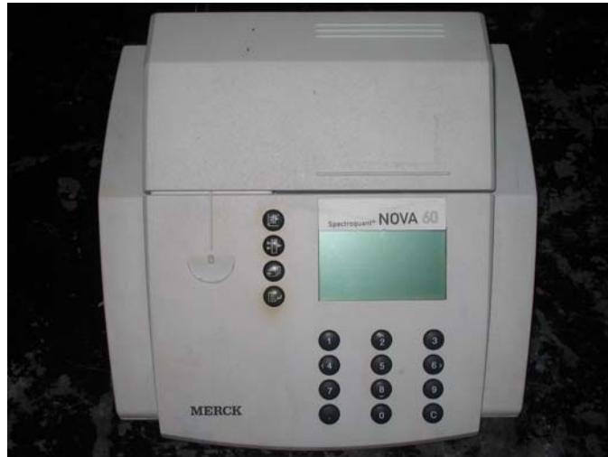
Fotografía 1. Espectrofotómetro MERCK Spectroquant Nova 60 para la determinación de DQO, \text{NO}_2^- , \text{NO}_3^- , \text{S}^{2-} y Ph.
