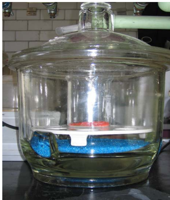
Fotografía 8. Desecador utilizado para preparar reactivos de las técnicas y para la determinación de SSV y SST.
