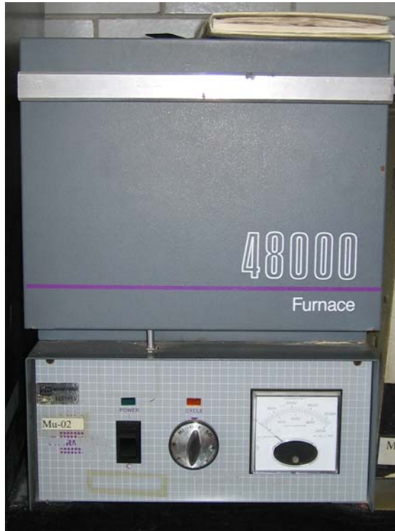
Fotografía 3. Mufla 48000 Furnace para determinación de SSV.
