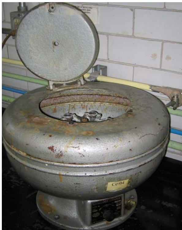
Fotografía 5. Centrifuga Internacional Centrifuge, modelo H, tipo 470. Utilizada para determinación de DQO, \text{NO}_3^- , \text{NO}_2^- , \text{S}^{2-} y Ph.
