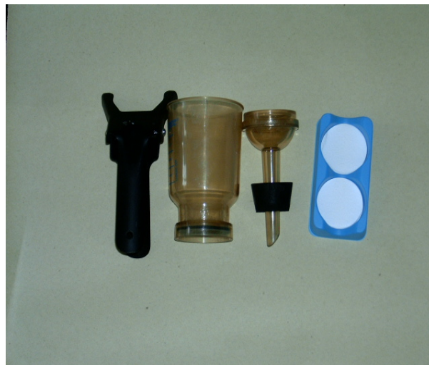
Fotografía 2. Sistema de filtración rápida para la determinación de SST y SSV.
