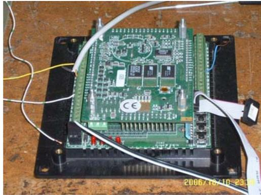
Figura 3.15 Tarjeta de adquisición LP3500 de Zworld
