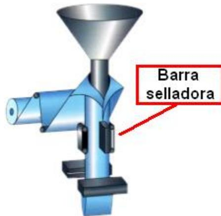
*Figura 4.12 Sistema de sellado longitudinal*
