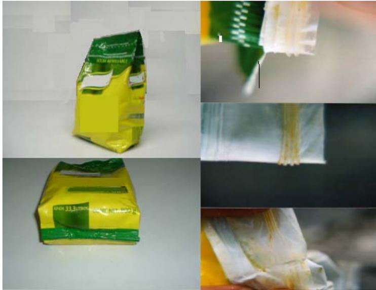
*Figura 3.2 Muestra de una bolsa tipo almohada con fuelle que incluye elemento resellable.*
