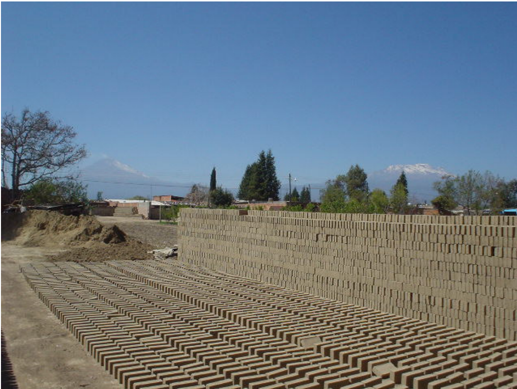
Figura 20. Tabiguera de la familia Tula en el municipio de Huejotzingo, Puebla. Los prismas de arcilla se dejan secar antes de cocerse para formar el tabique.
