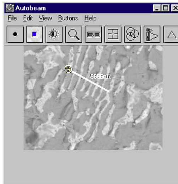
Fig. IV.40. Variación del contenido de plomo y estaño a través de una línea recta que atraviesa las laminas de alfa y beta.
