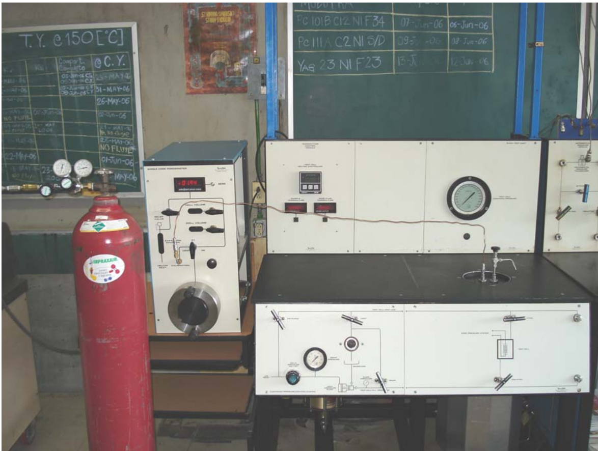
Figura 5. 23. Armado del Equipo para Realizar la Prueba de Compresibilidad.
