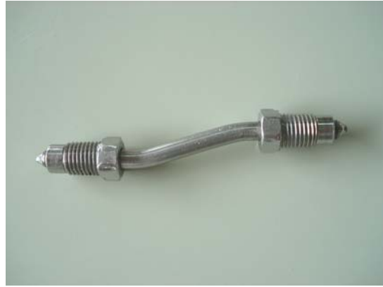
Figura 5.17. Conexión corta en forma de “S”.
