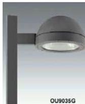
Luminaria punta de poste asimétrica para lámpara A.M. 250W. Material: Aluminio inyectado, Reflector de aluminio especular óptica asimétrica, Difusor de cristal templado. Acabado: Pintura horneada micropulverizada color gris texturizado. Lámpara: A. M. 250W. Base: E40. Equipo: Balastro inductivo 220V, integrado.
