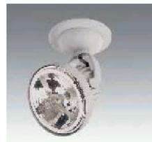
Luminaria dirigible con ceja antideslumbrante, de sobreponer en cánope, para lámpara AR111 50W. Material: Aluminio inyectado. Acabado: Pintura horneada micropulverizada color gris metálico texturizado. Lámpara: AR111 50W. Base: G53Equipo: Transformador electrónico, 127V/12V, integrado
