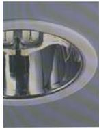
D/60, Reflector 2x13W para dos lámparas fluorescentes compactas sencillas de 13 W. Gabinete de acero zincado acabado en poliéster de aplicación electrostática conexión a 127V. Housing con dos balastos inductivos de 13W. Reflector de termoplástico metalizado especular en acabado oro y plata. Flujo luminoso 2x825 lm-1650 lm Temperatura de color 2700 o 4100oK
