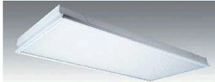
Luminaria de empotrar 2'X4' para lámpara fluorescente lineal T8 3x32W, (incluidas) Difusor de acrílico P1. Material: Acero formado, Difusor de acrílico P1. Acabado: Pintura horneada micropulverizada color blanco. Lámpara: T8 3x32W 4100oK Base: G1Equipo: Balastro electrónico 127V, integrado.
