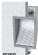
Luminaria de empotrar a muro para lámpara halógena doble base 100W. Material: Aluminio formado. Acabado: Pintura horneada micropulverizada color gris metálico texturizado. Lámpara: Halógena doble base 100W. Equipo: RX7S.
