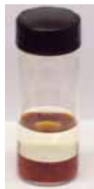
Figura 3.3. Separación del PFMC y del CHx a T_{amb} .
