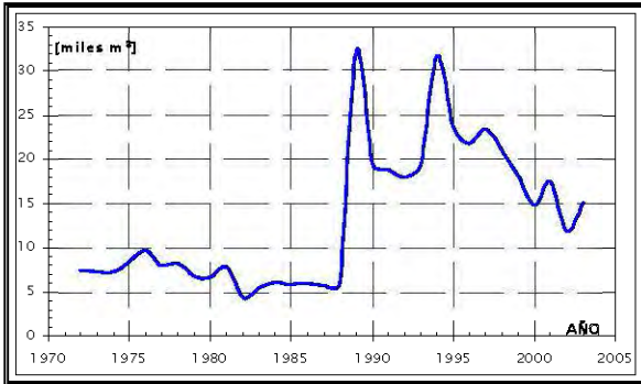
FIGURA VI.54 VOLÚMEN TOTAL ANUAL DE INFILTRACIÓN ZONA V
