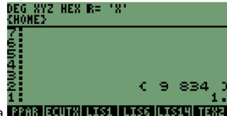
Debemos ver en la pila2 una lista de valores, en nuestro caso la lista será { 9 834 } y en la pila1 se obtendrá el valor “1”.
