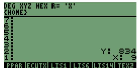
Ya con ambos valores como **ETIQUETAS**, podemos generar el mensaje para **"X"** y como sabemos que al cerrar el mensaje de la variable **"X"**, se despeja el contenido de la pila1, cambiando el contenido de la pila1 por él de la pila2.
