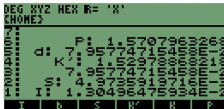
Con lo cual obtenemos los valores en la pila y podemos almacenarlos o copiarlos de la pila al cuaderno, como se observa en la pantalla se mantienen las variables tanto en la pila como en la memoria.
