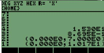
La pantalla es nuevamente se puede observar que se tiene un número a la izquierda del punto decimal y la cantidad que cambia es del lado derecho del punto; efectuamos una multiplicación para demostrar que el valor no se altera al redondear en la pantalla; multiplicamos la pila1 por **8**, la secuencia es
