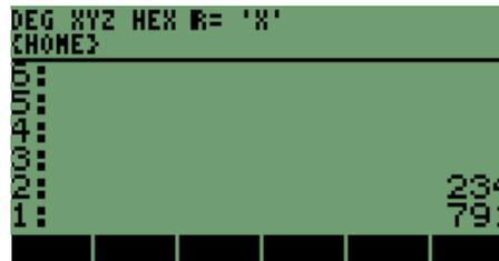
La pantalla debe verse de la siguiente forma, ya con los valores en la pila procedemos a realizar la operación de resta, sabiendo que el resultado nuevamente estará alojado en la pila 1:
