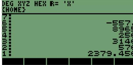
Se observa la reducción de valores en la pila y se tiene el resultado del paréntesis interno.
