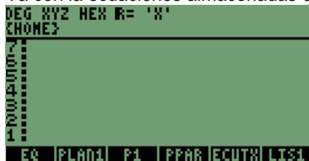
En este modelo al igual que en el modelo **HP49G+** se utiliza la instrucción “**MINIT**”, nos permite crear la variable “**Mpar**”, que es la que crean las calculadoras para iniciar la resolución de las ecuaciones, para posteriormente pasar a la solución de éstas.
