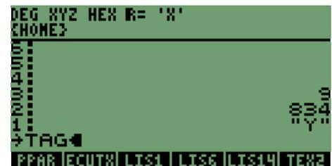
Cuando presionamos **ENTER**, automáticamente queda Etiquetado el valor de **834** con la letra **“Y”**.
