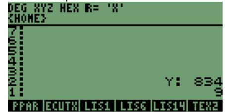
Con los valores ya intercambiados podemos seguir con colocar una **ETIQUETA** al valor y después cambiarlo a **TEXTO** para generar nuevamente un mensaje en la pantalla.
