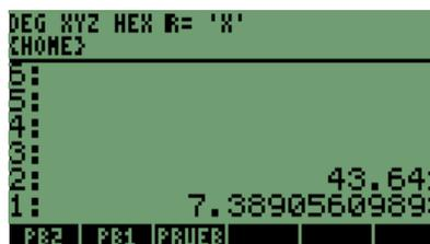
Se borra el valor de la pila1 y queda almacenada en la variable "PB2"
