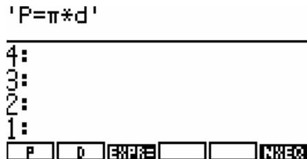
Ya ingresamos al modo de resolución rápida de ecuaciones; como se tiene en la siguiente pantalla. En la que se observan las variables que intervienen y la ecuación que se manipula; para ver las siguientes ecuaciones necesitamos presionar la tecla que tiene la etiqueta "NXEQ" y la tecla es "F" o "F6".
