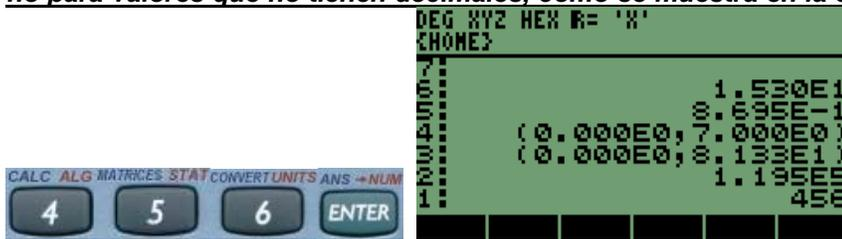
**Como se puede ver los valores anteriores si tiene visualizado el modo 3 SCI a diferencia del nuevo valor, esto pasa con los dos modos.**
