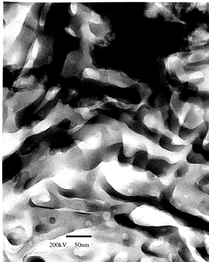
Fig. 2.3B. Imagen de MET del \text{Li}_2\text{SiO}_3 obtenido por el método de baja temperatura con relación molar 4:1 en urea 2M a un aumento de 120 000X
