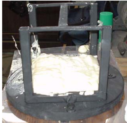
Figura 2.6 Aplicación de espuma aislante
