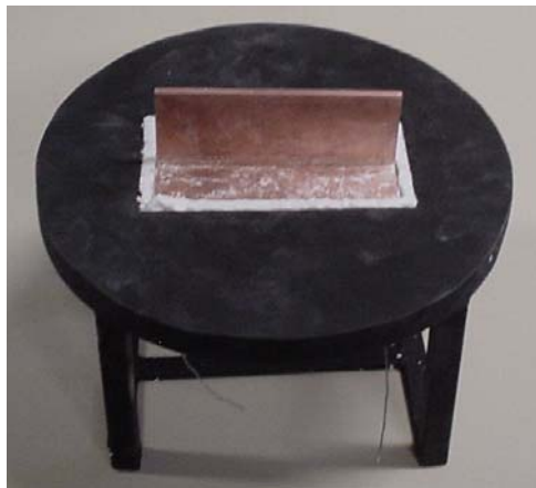
Figura 2.5 Fijación de la aleta sobre una base
