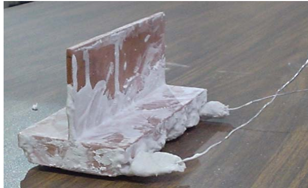
Figura 2.4 Colocación de resistencia eléctrica
