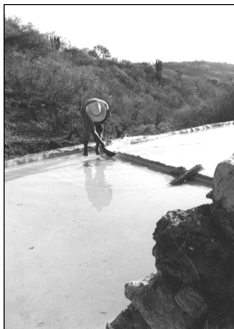
Figura 4.17. Uso del tecomate y la escoba de manzanilla para trasladar una salmuera concentrada, de un cajete a otro. Sta. María Silacayoapan Mixteca Baja, Oaxaca.
