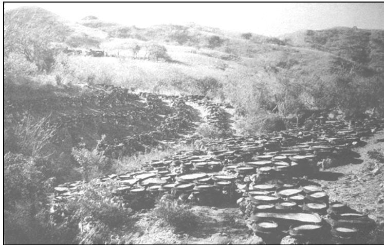
Figura 4.8. Tanto en Alahuiztlan, Gro., como en San Miguel Ixtapa, Méx., el antiguo método de evaporación solar en cajetes o poches, fue desplazado por la construcción de planchas de concreto adaptando las terrazas originales y utilizarlas como patios de evaporación.
