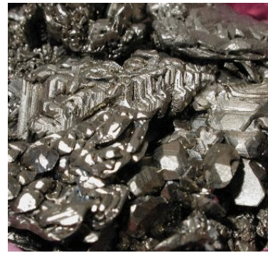
Fig. 4 Titanio obtenido por vía electrolítica. 12
