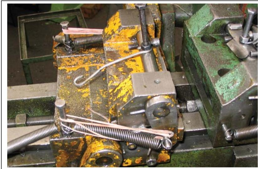
**Figura 7: Ligas en el regulador del paso de lámina**
