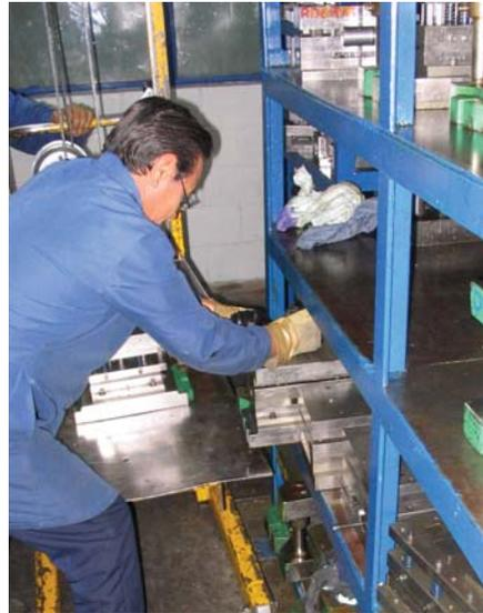
**Figura 2: Localización del troquel para su montaje**
